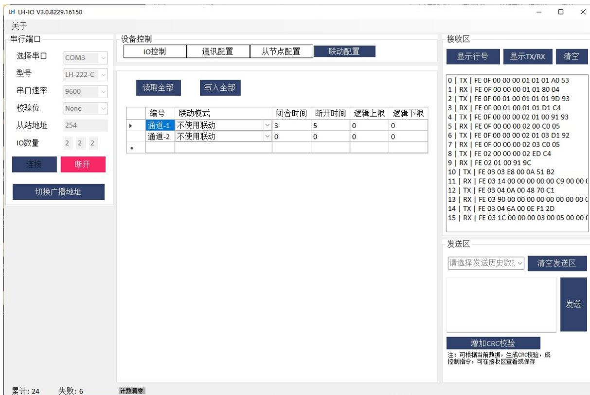
5、“从节点配置”页面可以进行从机传感器读取配置。配置相应的从机地址、功能码、寄存器地址、寄存器数量，控制器即可依照配置顺序依次读取对应传感器的数据。如果想删除某一个传感器，把对应的值设置为 0(功能码选择“无”)即可。此功能建议配合我司“小智物联网”小程序使用，配置更方便。
